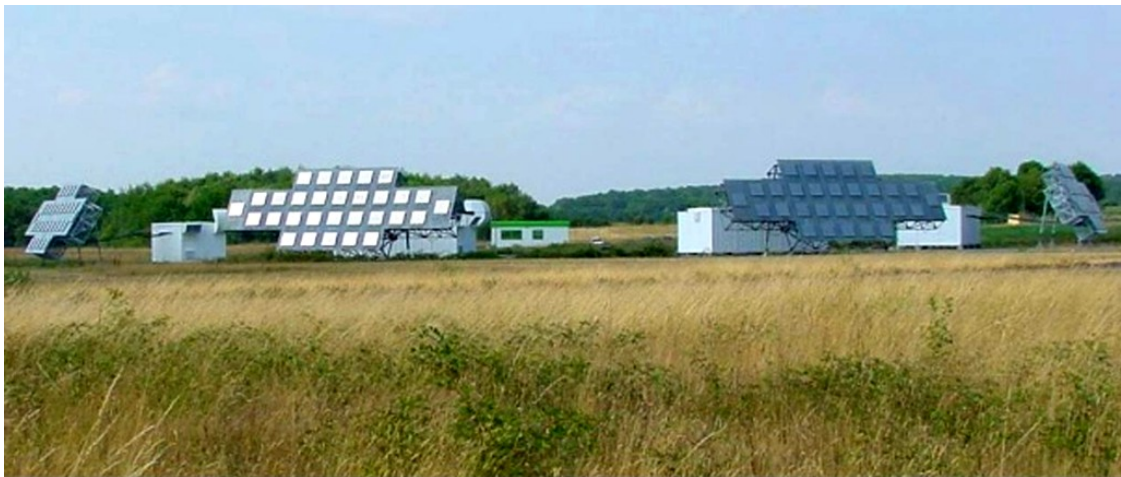
Abb.2: Panelantennen des GRAVES Radar (Bild: [5], [7])
