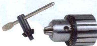
**Maschinen-Bohrfutter:** Mit Kegelaufnahme, für Rechts- und Linkslauf geeignet. Backen gehärtet und geschliffen nach DIN 238.
