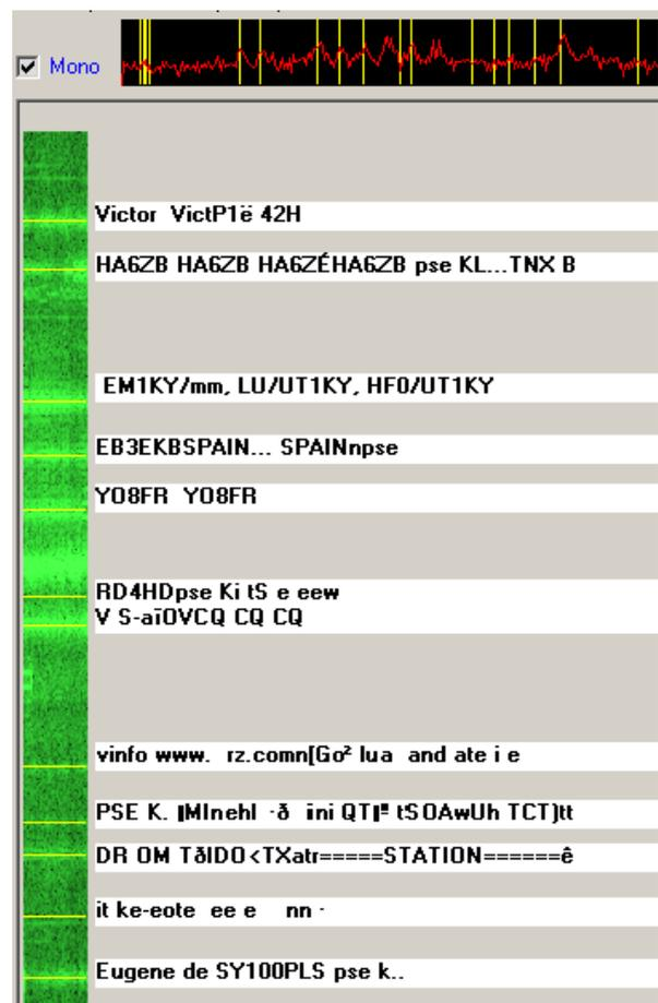
dicht benachbart sind, liefert das schmalbandigste verfügbare Filter (z.B. 200 Hz) bessere Ergebnisse (ein besseres Signal/Rausch-Verhältnis, keine Verringerung der Empfänger-Empfindlichkeit, wenn die AGC aufgrund einer starken Station innerhalb des Durchlassbereich herunterregelt, weniger Intermodulationsstörungen usw.). Das Wasserfalldiagramm zeigt dann nur die eine Station.
