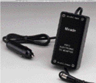
**Spezialwandler #1812:** Meade CDS- und EDS-Antriebe arbeiten mit einer Betriebsspannung von 18V=. Wenn Sie eines dieser Antriebssysteme im Feld von einer 12V= Batterie betreiben wollen, benötigen Sie diesen Spannungswandler, der aus 12V= die richtigen 18V= macht. Der Adapter ist nur 3x5x10 cm klein und wird in den Zigarettenanzünder Ihres Autos gesteckt; das Stromversorgungskabel hat eine Länge von 7,5 m.
